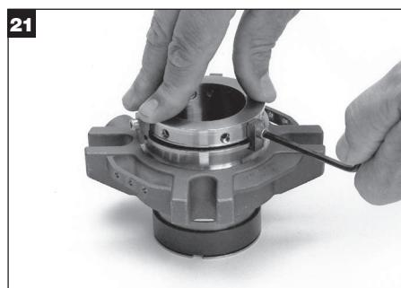
Trykk ned på låseringen og skru til de 1/4" hakesettskruene og hulende settskruene. Sjekk at hylsen ikke deformeres når du skru til settskruene. Pass på at settskruene ikke stikker frem i I.D. boringen. Installer og skru til sentreringsklemmene som følger: Skru hodeskruen lett til og bruk så en sekkskantnøkkel til å skru hodeskruene 1/8 omdreining til. Pass på at kanten på enden av sentreringsklemmene er inne i sporet i glanden. **Monteringen er nå fullstendig.**
