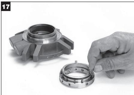
Smør låseringen O-ringer og plasser den i låseringen O-ringspor. Pass på at rette skruer er i låseringen. Det skulle være tre hulende settskruer og tre hybride hake/hulende-settskruer som er plassert vekselsvis i de større hullene på låseringen. (Det er seks hulende settskruer for størrelser på over 60 mm og 2,5 tommer). Plasser en fjær i hvert hull i låseringen. Påfør en liten mengde silikonsmørefett i bunnen av hver fjær. Dette vil hjelpe til med å holde fjærene i hullene.
