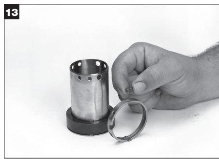
Hvis de to drivklemmene ikke allerede er satt fast, installer de to drivklemmene i spaltene i flytkanalen. Merk: Det er fire drivklemmer for størrelser på over 60 mm og 2,5 tommer.
