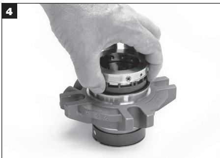
Løft låseringen og rotasjonsmontasjen forsiktig ut mens du holder den roterende tettingsringen og låseringen. Dette vil gjøre at den roterende tettingsringen ikke faller av. Plasser låseringmontasjen med den roterende tettingsringsiden opp.
