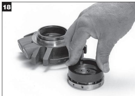
La den utvendige roterende tetningsringen gli over låseringen til den er over o-ringene mens du retter inn drivtappene med rotasjonsspalten. Trykk på den roterende tetningsringen slik at fjærene trykkes sammen og pass på at den roterende tetningsringen kan bevege seg fritt. Tørk av overflaten på den stasjonære og den roterende tetningsringen med en støvfri klut.
